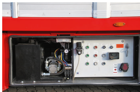
Teknikskabet hvorfra alle trailerens funktioner styres.
