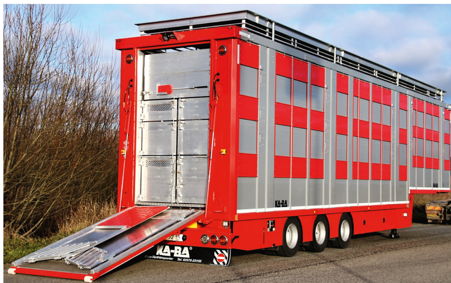
Traileren tag er hævet, og læsserampen er aktiveret.
